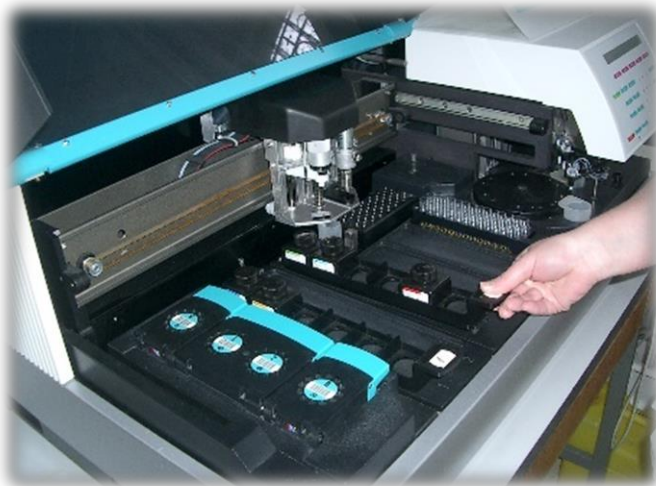
Vkladanie vzoriek bioogického materiálu do PCR analyzátora na génovú diagnostiku tuberkulózných mykobaktérií
